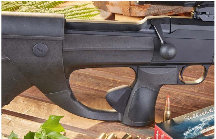
**Eine sichere Sache:** Das Handspannersystem der Dentler DR21 wird über den Handballen gesteuert, durch Eindrücken wird die Feuerbereitschaft hergestellt.
