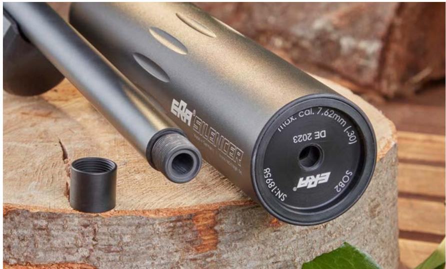
Unter dem Schutzkappchen trägt die blitzsauber hinterdrehte Mündung ein M15x1-Gewinde. In Verbindung mit dem mitgelieferten Schalldämpfer von Eratac schoss sich die 308er Testwaffe nicht nur schön leise, sondern auch außergewöhnlich sanft.
