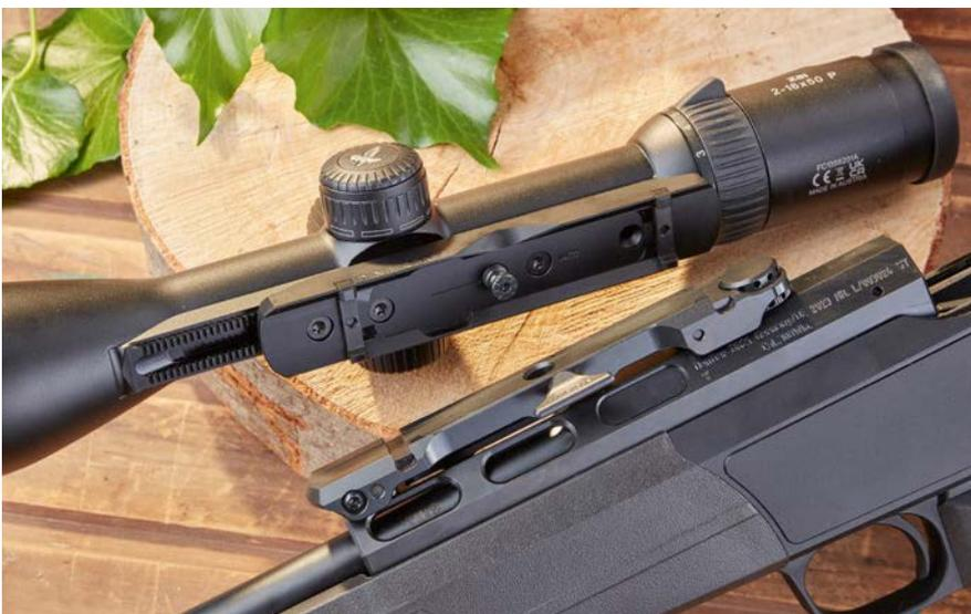
Die Dentler-Montage Basis Vario. Ein Zapfen in der Mitte sowie Querstollen vorn und hinten sorgen für festen Halt, zudem ist die Montage in Höhe und Seite verstellbar.
