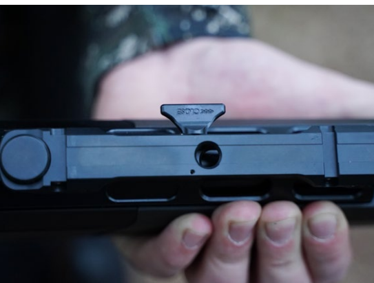
Serienmäßig montiert Dentler die Grundschiene Basis-Vario zum Anbringen einer Zielloptik an seinen Geradezugrepetierer.
