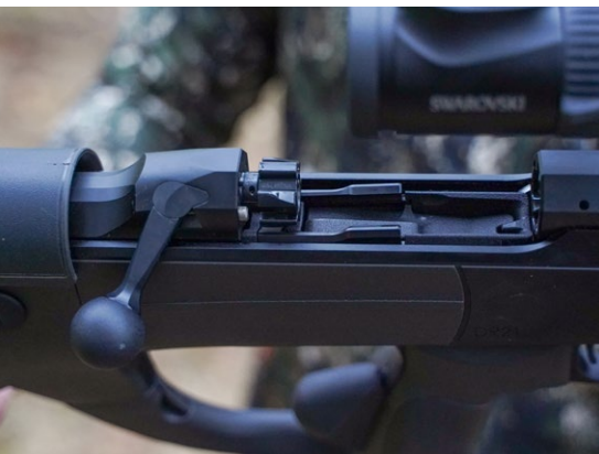
Der Verschluss mit sechs Verriegelungswarzen garantiert laut Angaben des Herstellers Langlebigkeit und Belastbarkeit.
